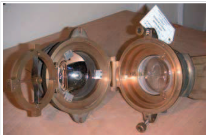
Une des chambres photographiques catadioptriques ouverte à F/0,65 du spectrographe nébulaire de la mission « comète artificielle ». Crédit photo : HR. Monument Historique
