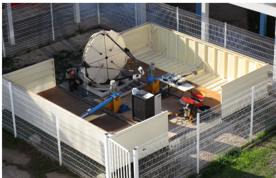
FIGURE 2.28 – Vue d'ensemble du LIDAR dans son conteneur.
